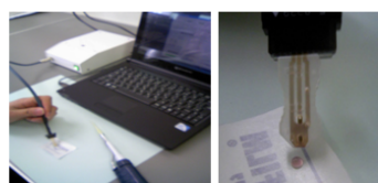
試作したフェニルアラニンセンサシステムとその電気化学計測原理
