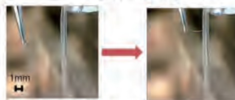
力覚フィードバックによる模擬血管刺入実験の様子 (オペレータが「針が接触した」と感じた瞬間に停止している)
