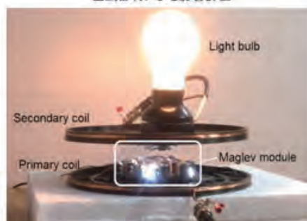
磁気浮上キットと非接触電力伝送
