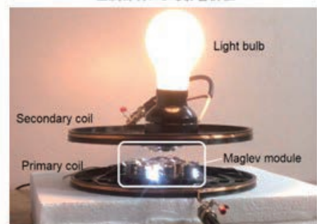
磁気浮上キットと非接触電力伝送
