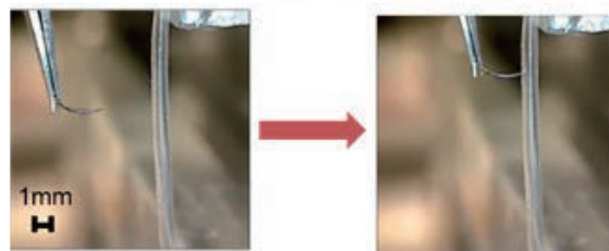
力覚フィードバックによる模擬血管刺入実験の様子 (オペレータが「針が接触した」と感じた瞬間に停止している)
