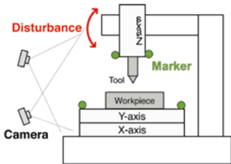
図3 精密な機械システムの運動計測への応用
