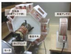
非接触電力伝送評価装置 (送信アンテナ8個設置時)
