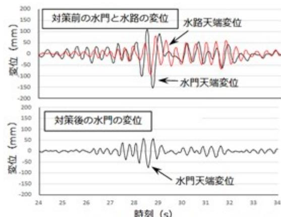
図2 水門の制震効果（動的解析結果）
